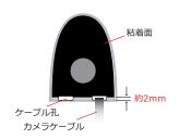
※カメラケーブルが車体表面に接触すると、 粘着面の一部しか密着せず、十分な固定ができません。 その結果、カメラが剥がれ落ちる可能性があります。 しっかりと粘着面全体が車体に貼り付くように調整してください。
